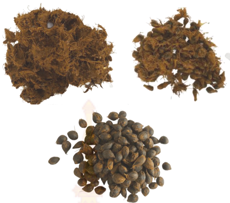
ภาคผนวก ก 21 เนื้อปาล์ม เมล็ดในปาล์มและเนื้อปาล์ม เมล็ดในปาล์มดี แรงกด 6.5 กิโลกรัม แผ่น กดลายกันหอย แผ่นฉีกเส้นโค้ง ทดลองครั้งที่ 3
