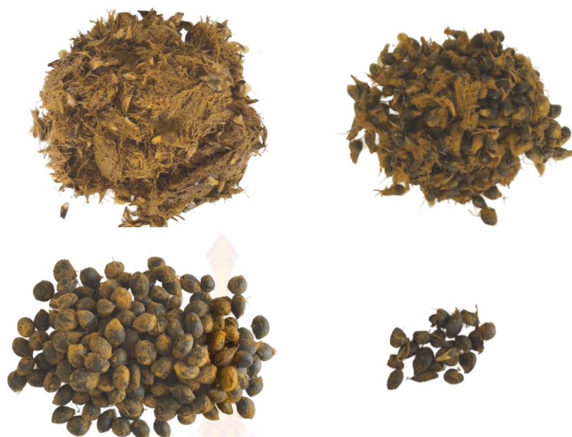
ภาคผนวก ก 11 เนื้อปาล์ม เมล็ดในปาล์มและเนื้อปาล์ม เมล็ดในปาล์มดี เมล็ดในปาล์มแตก แรงกด 12.5 กิโลกรัม แผ่นกดลายตาข่าย แผ่นฉีกเส้นโค้ง ทดลองครั้งที่ 2
