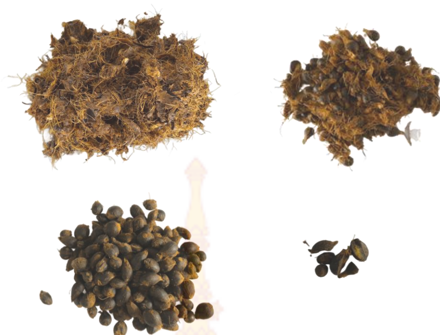
ภาคผนวก ก 17 เนื่อปาล์ม เมล็ดในปาล์มและเนื่อปาล์ม เมล็ดในปาล์มดี เมล็ดในปาล์มแตก แรงกด 12.5 กิโลกรัม แผ่นกดลายกันหอย แผ่นฉีกเส้นตรง ทดลองครั้งที่ 2
