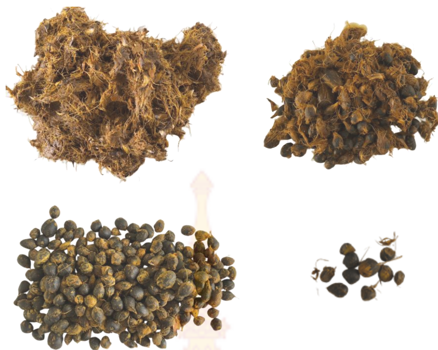
ภาคผนวก ก 13 เนื้อปาล์ม เมล็ดในปาล์มและเนื้อปาล์ม เมล็ดในปาล์มดี เมล็ดในปาล์มแตก แรงกด 6.5 กิโลกรัม แผ่นกดลายนกฮอย แผ่นฉีกเส้นตรง ทดลองครั้งที่ 1
