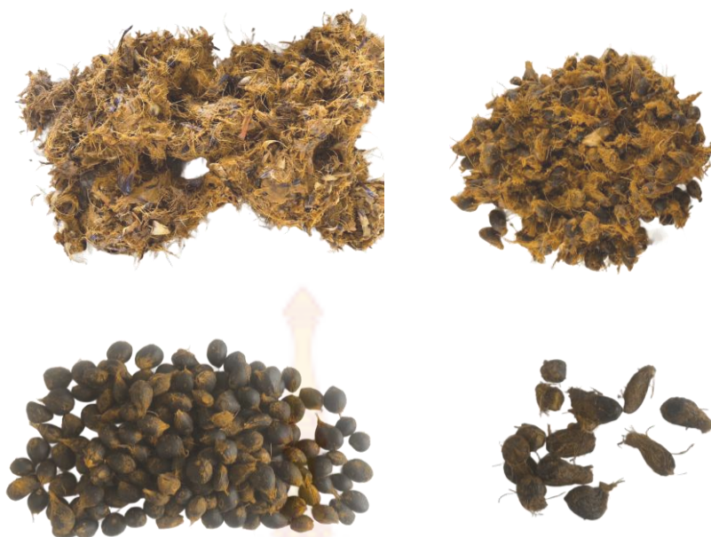
ภาคผนวก ก 5 เนื้อปาล์ม เมล็ดในปาล์มและเนื้อปาล์ม เมล็ดในปาล์มดี เมล็ดในปาล์มแตก แรกกด 12.5 กิโลกรัม แผ่นกดลายตาข่าย แผ่นฉีกเส้นตรง ทดลองครั้งที่ 2
