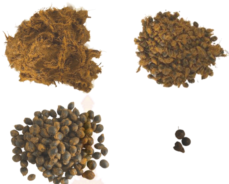
ภาคผนวก ก 19 เนื้อปาล์ม เมล็ดในปาล์มและเนื้อปาล์ม เมล็ดในปาล์มดี เมล็ดในปาล์มแตก แรงกด 6.5 กิโลกรัม แผ่นกตลายกันหอย แผ่นฉีกเส้นโค้ง ทดลองครั้งที่ 1
