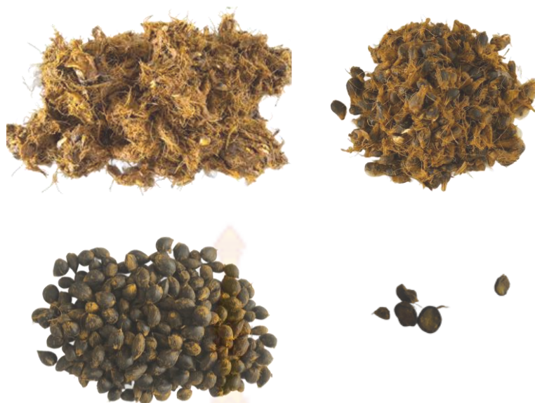
ภาคผนวก ก 15 เนื้อปาล์ม เมล็ดในปาล์มและเนื้อปาล์ม เมล็ดในปาล์มดี เมล็ดในปาล์มแตก แรงกด 6.5 กิโลกรัม แผ่นกดลายน้อย แผ่นฉีกเส้นตรง ทดลองครั้งที่ 3
