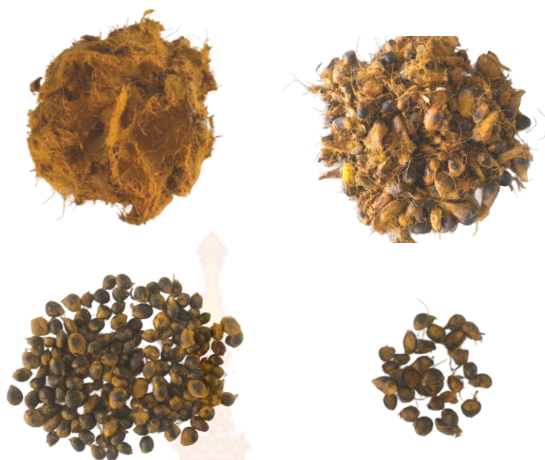
ภาคผนวก ก 3 เนื้อปาล์ม เมล็ดในปาล์มและเนื้อปาล์ม เมล็ดในปาล์มดี เมล็ดในปาล์มแตก แรงกด 6.5 กิโลกรัม แผ่นกดลายตาข่าย แผ่นฉีกเส้นตรง ทดลองครั้งที่ 3
