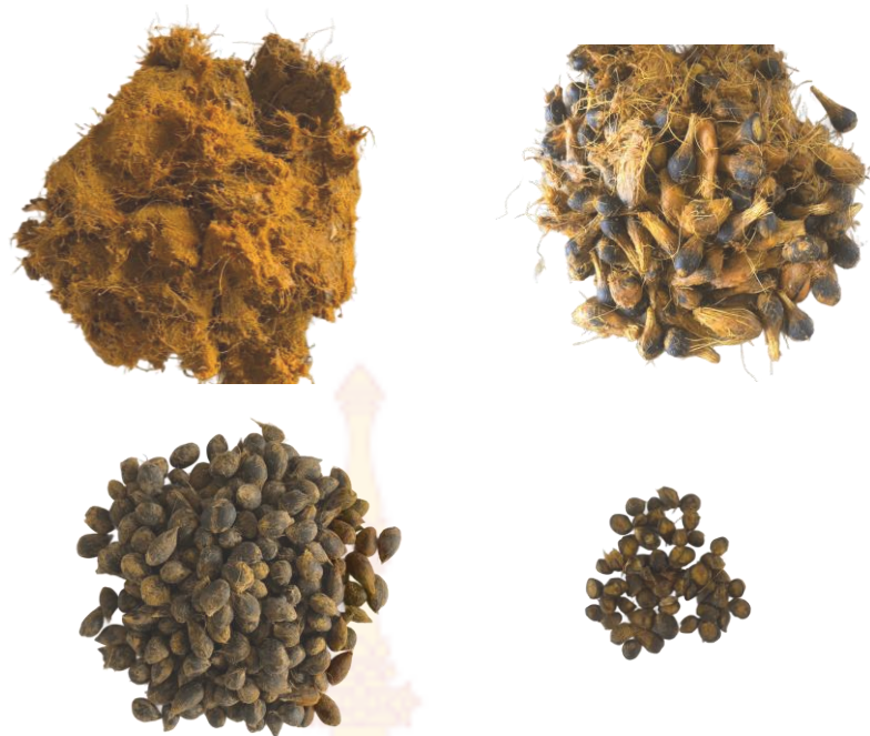
ภาคผนวก ก 1 เนื้อปาล์ม เมล็ดในปาล์มและเนื้อปาล์ม เมล็ดในปาล์มดี เมล็ดในปาล์มแตก แรงกด 6.5 กิโลกรัม แผ่นกดลายตาข่าย แผ่นฉีกเส้นตรง ทดลองครั้งที่ 1
