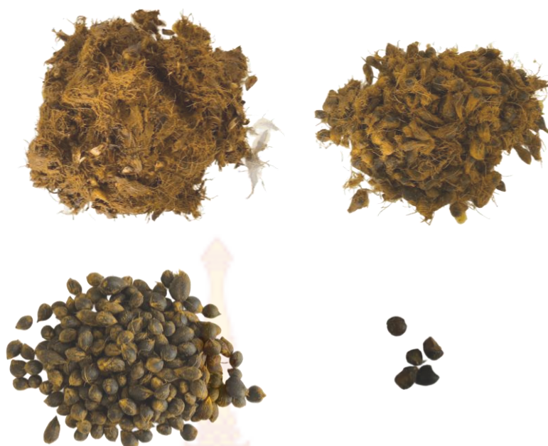
ภาคผนวก ก 7 เนื้อปาล์ม เมล็ดในปาล์มและเนื้อปาล์ม เมล็ดในปาล์มดี เมล็ดในปาล์มแตก แรกกด 6.5 กิโลกรัม แผ่นกตลายตาข่าย แผ่นฉีกเส้นโค้ง ทดลองครั้งที่ 1
