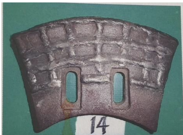
ภาพที่ 2.3 ใบผสมดินเชื่อมพอกแข็งลายแนวเชื่อมแบบตาข่ายก่อนการใช้งาน (อ้างอิง : สุพร, 2547, หน้าที่ 63)
