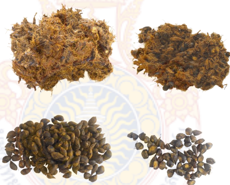
ภาคผนวก ก 4 เนื้อปาล์ม เมล็ดในปาล์มและเนื้อปาล์ม เมล็ดในปาล์มดี เมล็ดในปาล์มแตก แรงกด 12.5 กิโลกรัม แผ่นกดลายตาข่าย แผ่นฉีกเส้นตรง ทดลองครั้งที่ 1
