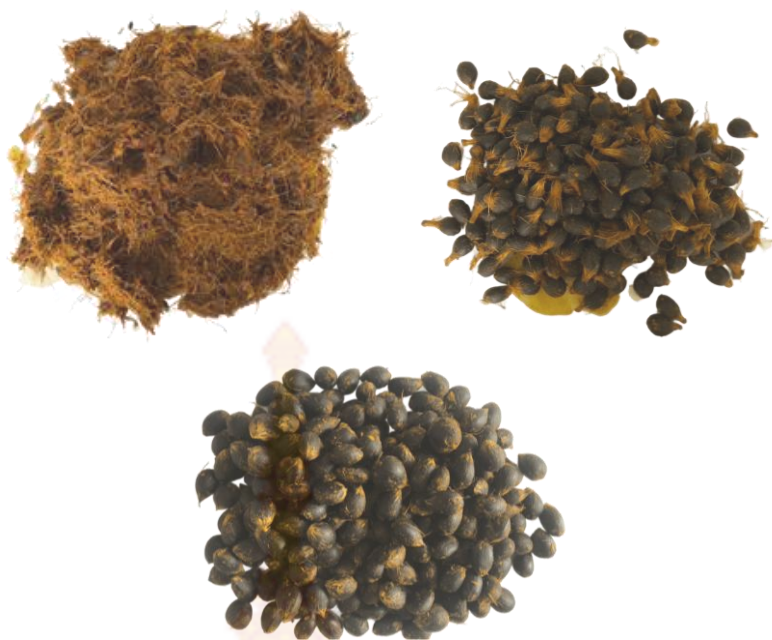
ภาคผนวก ก 23 เนื้อปาล์ม เมล็ดในปาล์มและเนื้อปาล์ม เมล็ดในปาล์มดี เมล็ดในปาล์มแตก แรงกด 12.5 กิโลกรัม แผ่นกดลายกันหอย แผ่นฉีกเส้นโค้ง ทดลองครั้งที่ 2
